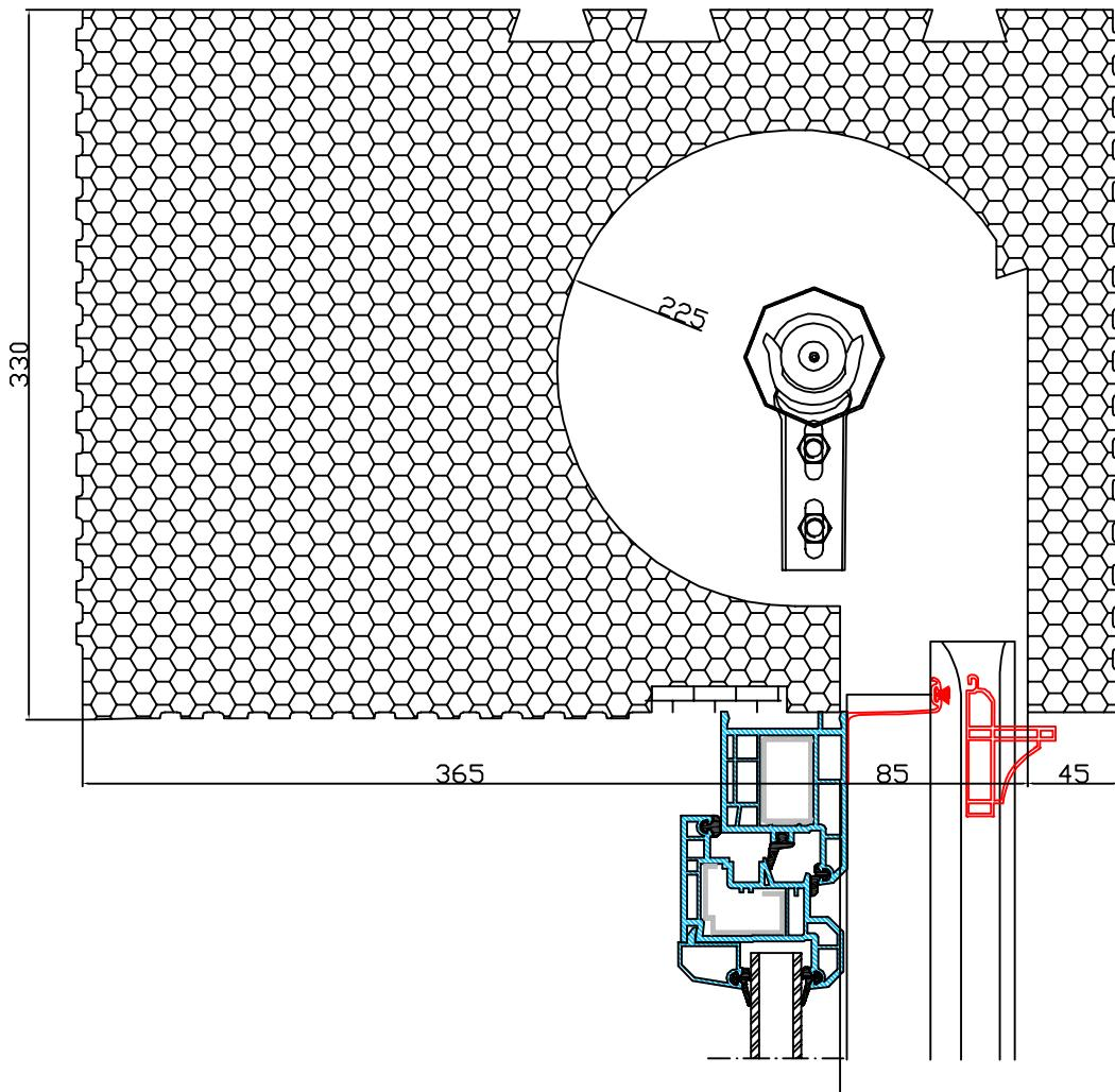
Leichtbaurollladenkasten RWS4000 MS30, raumseitig geschlossen, nicht selbsttragend, bestehend aus schwer entflammbarem, verrottungsfreiem Neopor 031.
